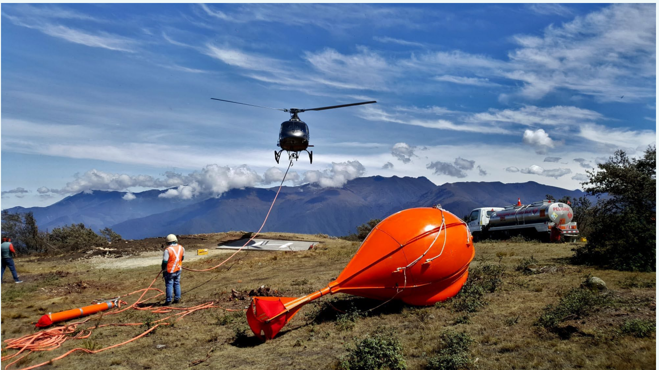
Figur 13: Exempel på en flygburen MTm-mätning ( https://expertgeophysics.com/services/ )
